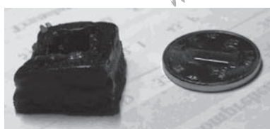
图6 纤维素凝胶3D打印成品
